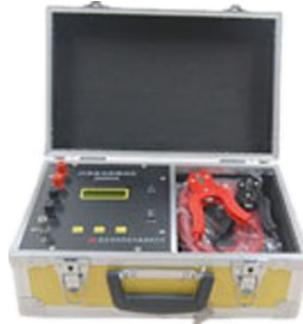
测量变压器绕组的直流电阻是一个很重要的试验项目，在《电力设备试验规程》中，其次序排在变压器试验项目的第二位，《规程》规定在变压器交接、大修、小修、变更分接头位置、故障检查及预试等，必须测量变压器绕组的直流电阻，ZRC-3A 直流电阻快速测试仪（微欧计）是取代直流单、双臂电桥的高精度换代产品。是测量电力变压器及大型电机等各种感性负载电阻及低压开关接触电阻、电线电缆或焊缝接口电阻的理想仪器，其测量速度比电桥快一百多倍。
