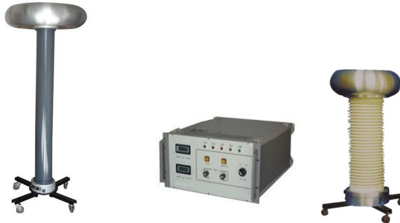
高稳定度直流高压电源适用于各级计量传递部门、各省电科院建立直流高压标准。该设备是我单位在多年从事高电压设备研制基础上精心设计而成的。控制部分采用高稳定度电压基准，高精度高压取样分压器，多重隔离、双闭环反馈稳压电路，所有元件全部经过严格筛选，关键部件全部选用进口元件。输出电压稳定度高，保证了高测量精度。
