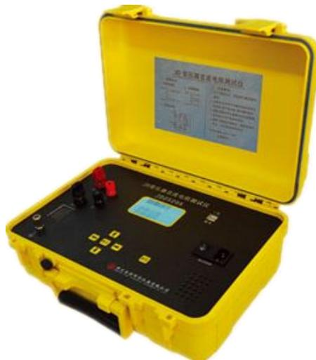
本仪器是专门为绕组电阻测量而设计的快速测试设备。该仪器采用单片机作为系统处理的核心，对整机进行控制，自动完成校验、稳流判断、数据处理、阻值显示等功能，尤其适合大中型变压器绕组电阻的测量。
